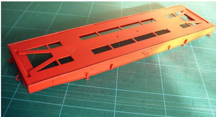
Für die Blechrollen Rahmen klebt man in die Schlitzte des Bodens die Innen-Hauptstütze, angeordnet in zwei Reihen.
